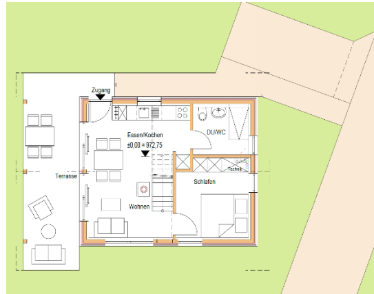
Grundriss eines Tiny Hauses, Quelle: Architekturbüro Kaiser 2024
